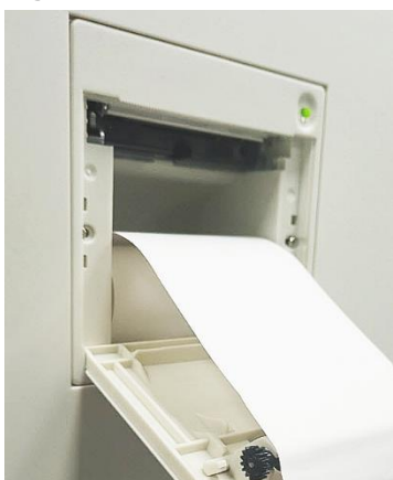
Figura 2-5 Instalación del papel térmico (2)
